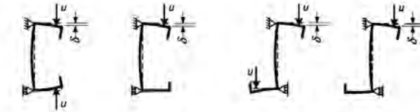
Figura C4.2.32 –Schemi di calcolo per la determinazione della costante elastica
